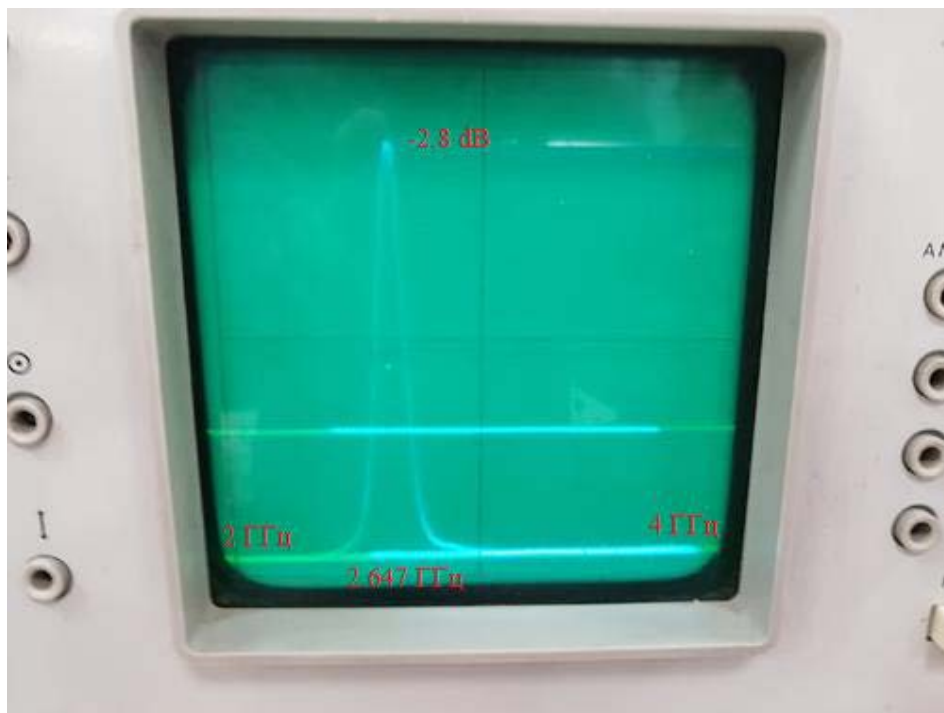
Рис. 6. Характеристика ослабления в частотном диапазоне 2–4 ГГц
