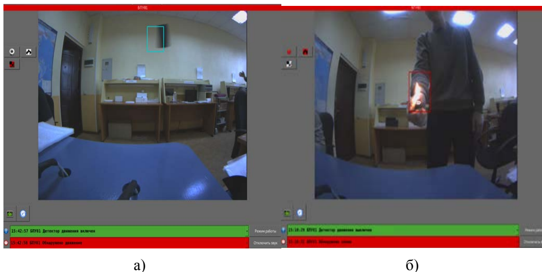
Рис. 2. Фиксация обнаружения перемещения: а) предмета, б) пламени
