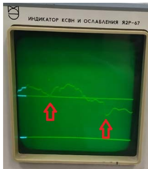
Рис. 6. Характеристика, полученная в процессе измерения КСВН и частот. Стрелками отмечены провалы КСВН
