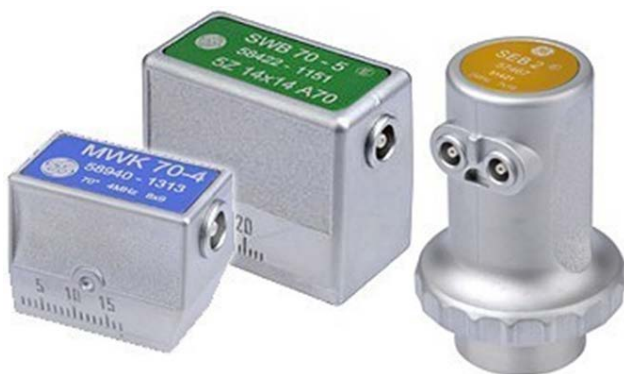
Рис. 2. Преобразователи: 2 совмещённых и раздельно-совмещённый [8]
