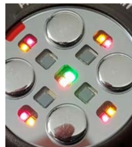
Рис. 4. Расположение оптических элементов датчика на часах Polar Grit X Pro
