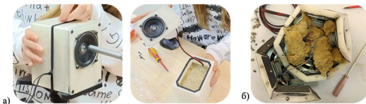
Рис. 1. Закрытое акустическое оформление (ЗАО) для одной головки громкоговорителя (а); громкоговоритель-додекаэдр с 12-ю ГГ (б)
