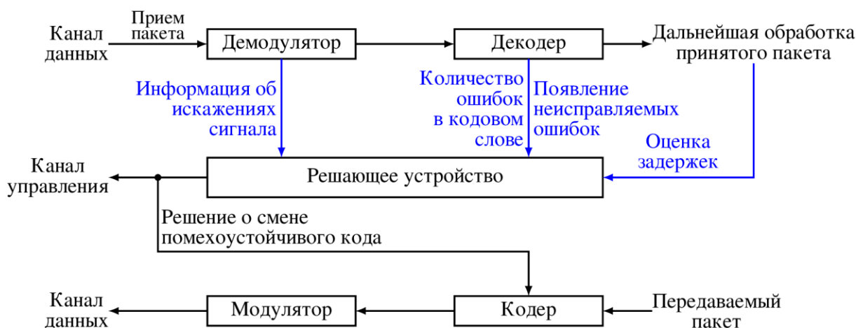
Рис. 1. Блок-схема приемопередатчика с адаптивным помехоустойчивым кодированием
