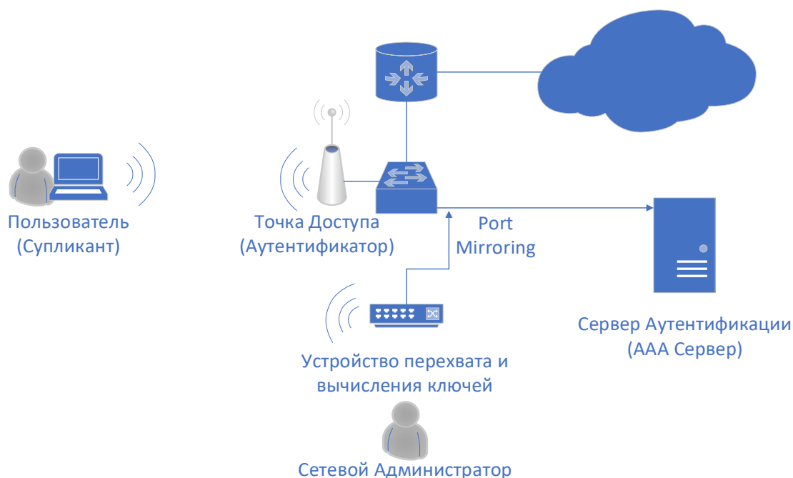
Рис. 2. Архитектура решения для мониторинга трафика сети 802.1X
