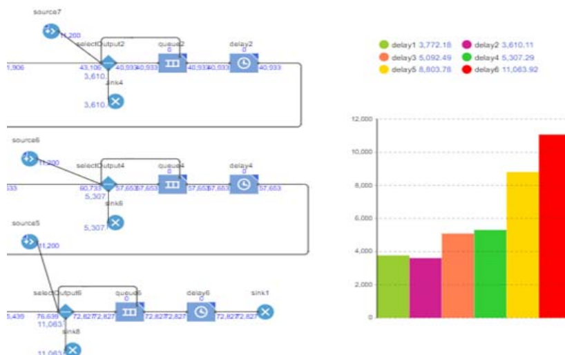
Рис. 4. Имитационная модель сети связи после воздействия дестабилизирующих факторов и выхода из строя маршрутизатора x_4
