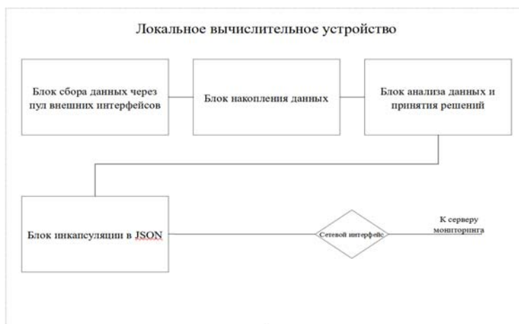
Рис. 4. Функциональная схема инкапсуляции данных
