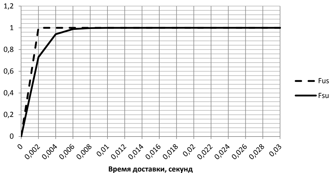
Рис. 3. Функции распределения времени доставки пакета на «последней миле сервера» при асимметричном распределении каналов
