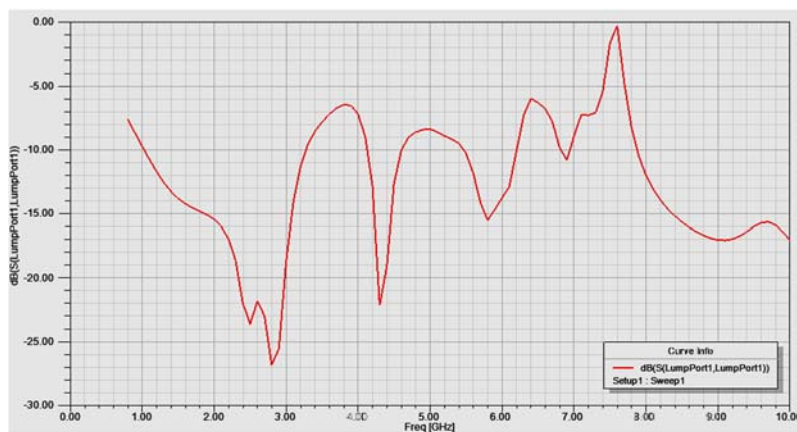
Рис. 6. График S11 параметра от частоты в диапазоне от 800 МГц до 10 ГГц
