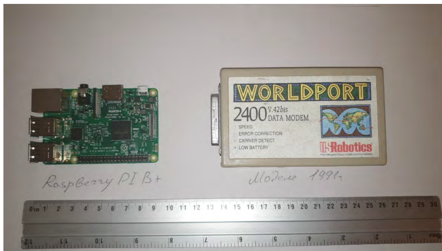
Рис. Микрокомпьютер Raspberry PI и модем 1989 года выпуска
