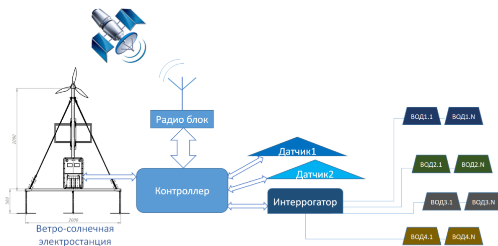
Рис. 1. Блок-схема комплекса природного мониторинга [10]
