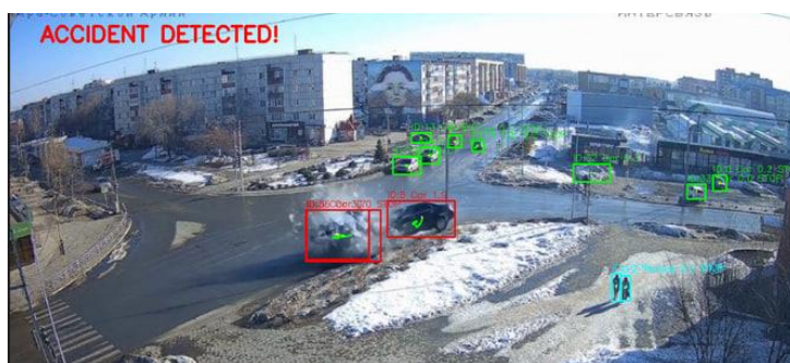
Рис. 2. Демонстрационный пример выделения объектов и фиксации признаков аварийной ситуации на видеопотоке городской камеры.
