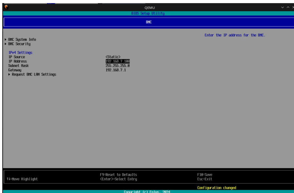
Рис. 2. Пример экранного интерфейса BIOS для конфигурации BMC
