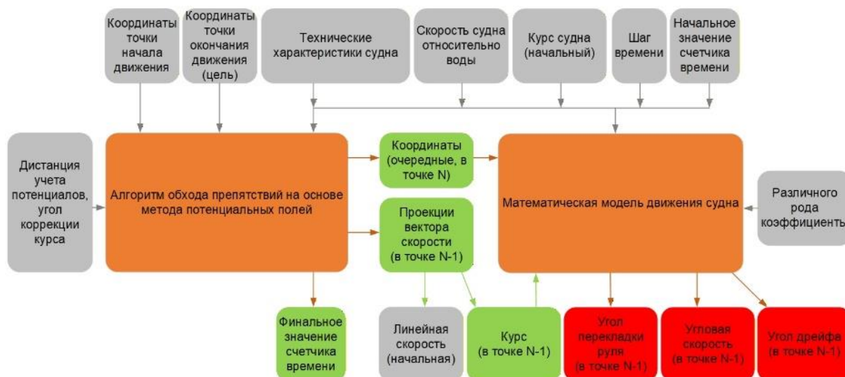
Рис. 1. Связь алгоритма обхода препятствий с математической моделью движения судна
