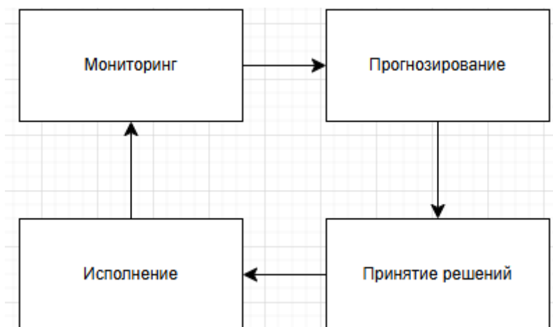
Рис 1. Замкнутый цикл управления
