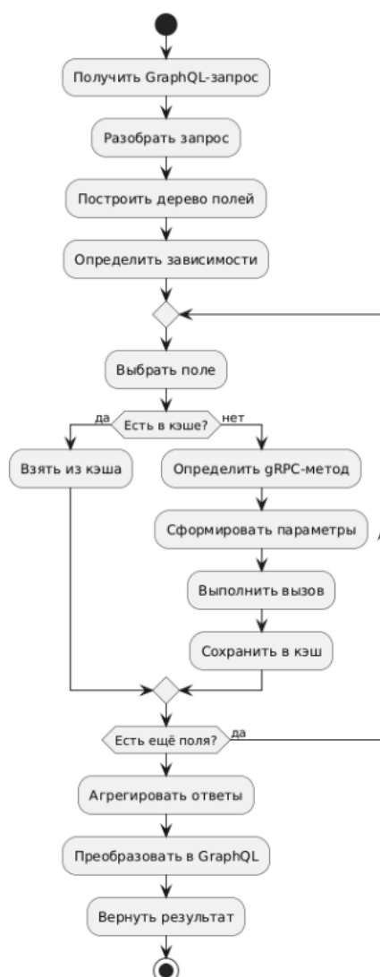
Рис. 2. Алгоритм сопоставления GraphQL-схемы с вызовами gRPC и последующей агрегацией ответа
