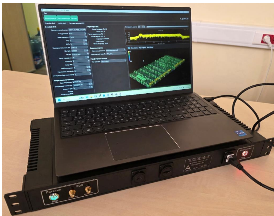
Рис. 1. Внешний вид генератора LTE с подключением к управляющей станции
