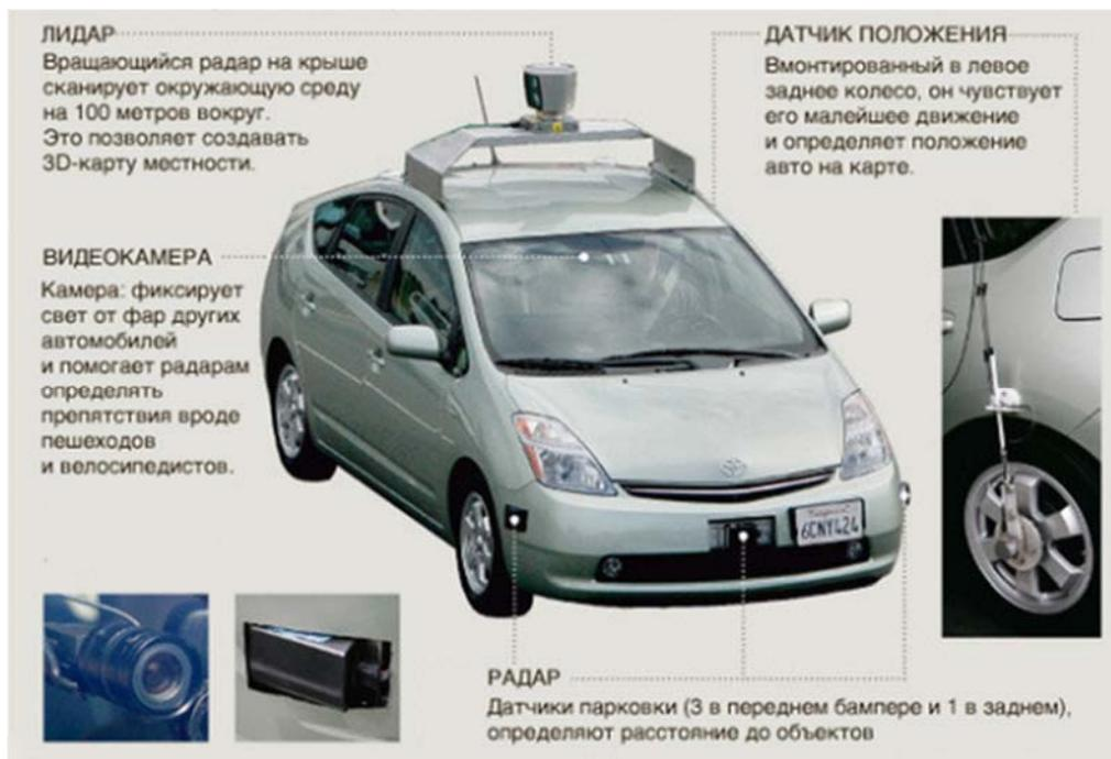
Рис. 1. Модель беспилотного автомобиля с используемыми датчиками
