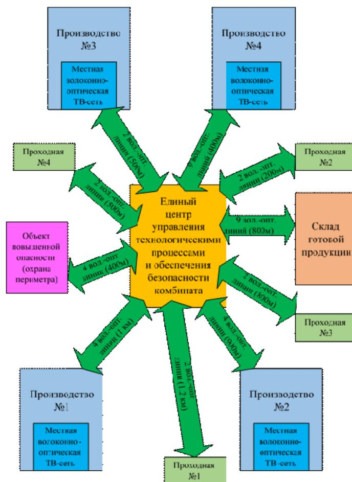
Рис. 1. Структурная схема сети производственного предприятия
