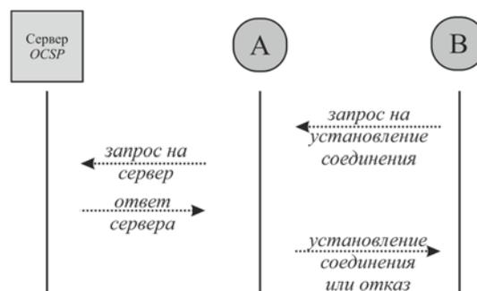
Рис. 2. Механизм работы МПСС OCSP
