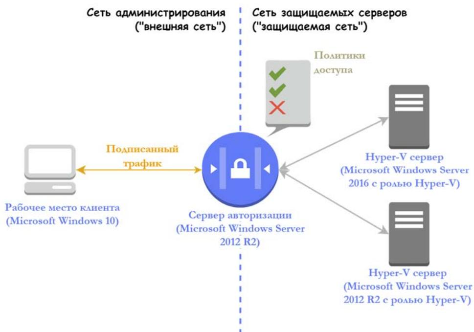
Рис. 2. Архитектура сети и размещение компонентов после инсталляции vGate 4.0
