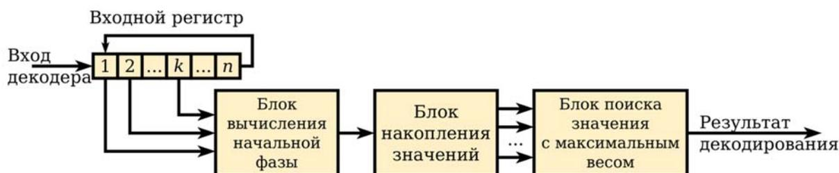
Рис. 2. Блок-схема мажоритарного декодера на основе двойственного базиса
