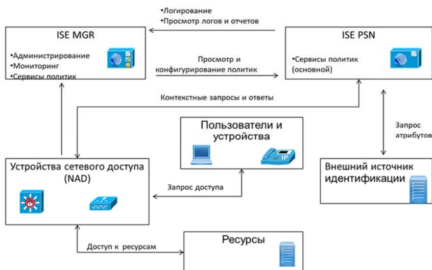
Рисунок. Схема взаимодействия устройств в архитектуре Cisco ISE
