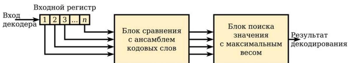
Рис. 1. Блок-схема декодера по минимальному расстоянию
