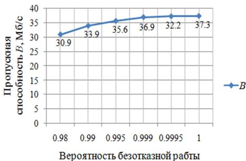
Рис. 4. Графическая зависимость пропускной способности от вероятности безотказной работы
