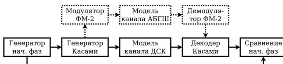
Рис. 1. Модель системы передачи для определения вероятностных характеристик синхронного декодирования последовательности Касами по методу двойственного базиса
