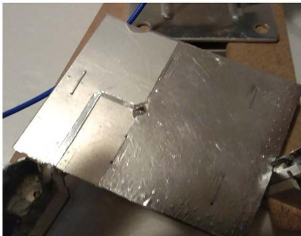
Рис. 4. Т-делитель с симметричной полосковой линией на входе
