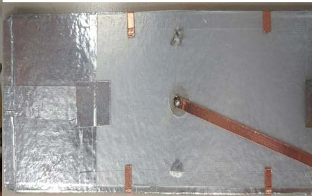
Рис. 5. Т-делитель с компланарной линией на входе
