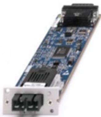
Рис. 1. Плата расширения STM-1/OC-3 для внутреннего блока
