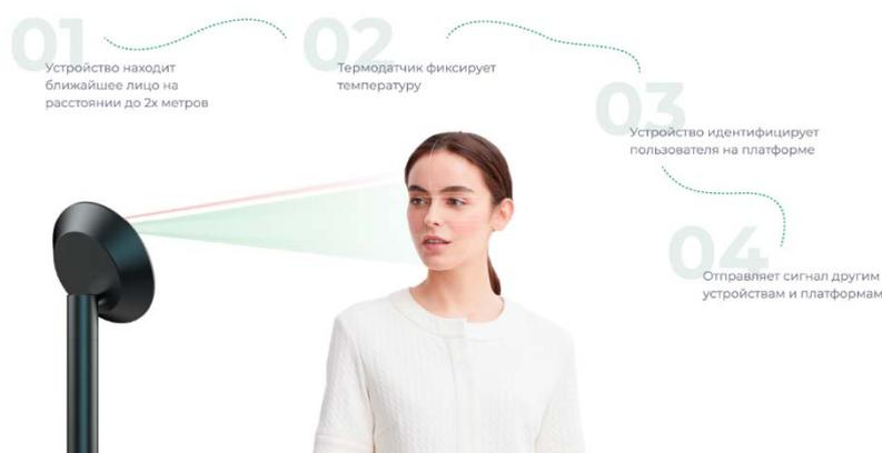
Рис. 1. Принцип работы устройства [4]
