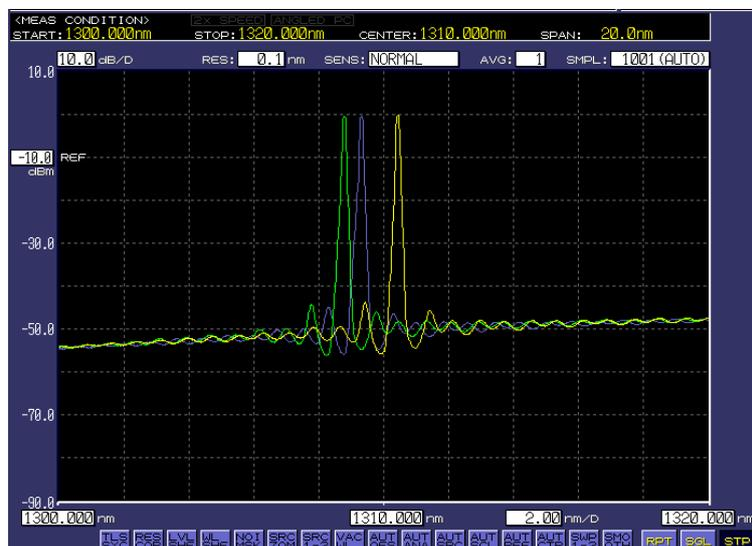
Рис. 2. Спектральные характеристики SFP-модуля при температуре – 5, 20 и 50°С
