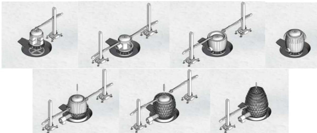
Рис. 5. Последовательность строительства жилых модулей
