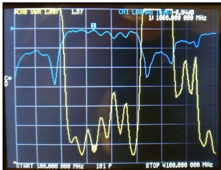
Рис. 7. Результаты измерения макета Т-делителя с симметричной полосковой линией на входе
