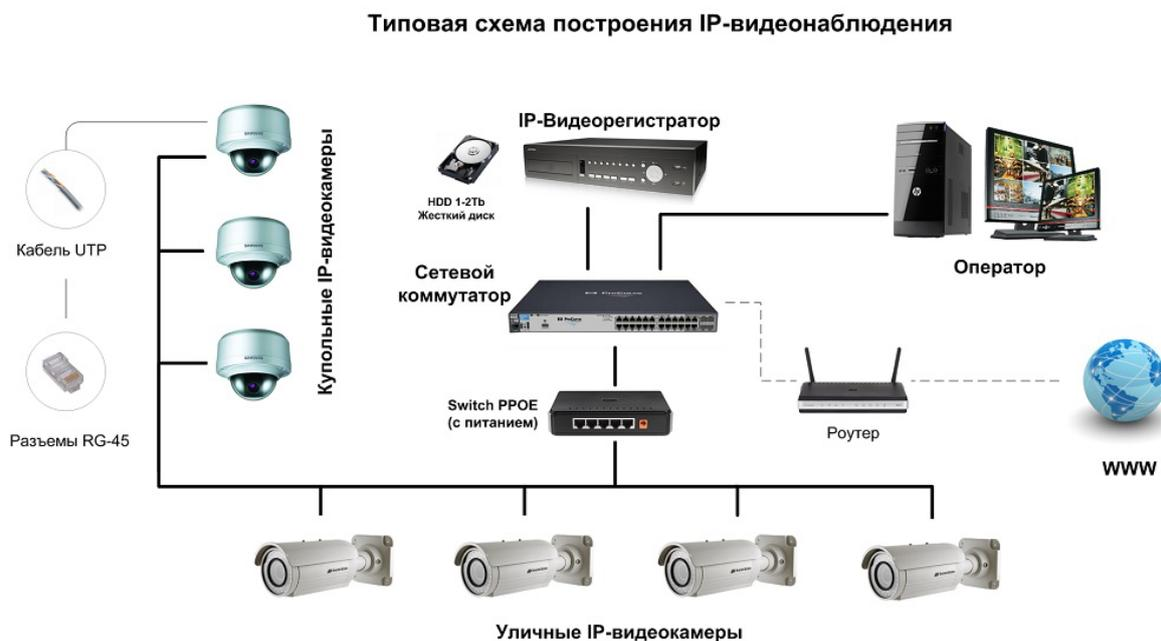
Рис. 1. Типовая схема построения системы видеонаблюдения с использованием IP-протокола
