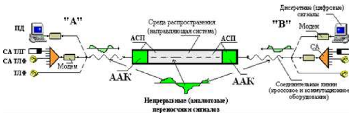
Рис. 1. Принципы построения аналоговых военных линий и ПСС
