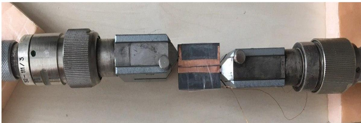
Рис. 1. Макет направленного ответвителя с центральной частотой 3.9 ГГц [4]
