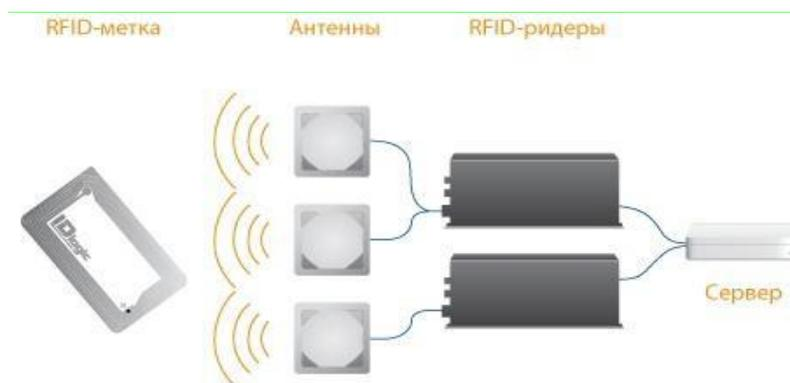
Рис. 1. Структурная схема работы технологии RFID
