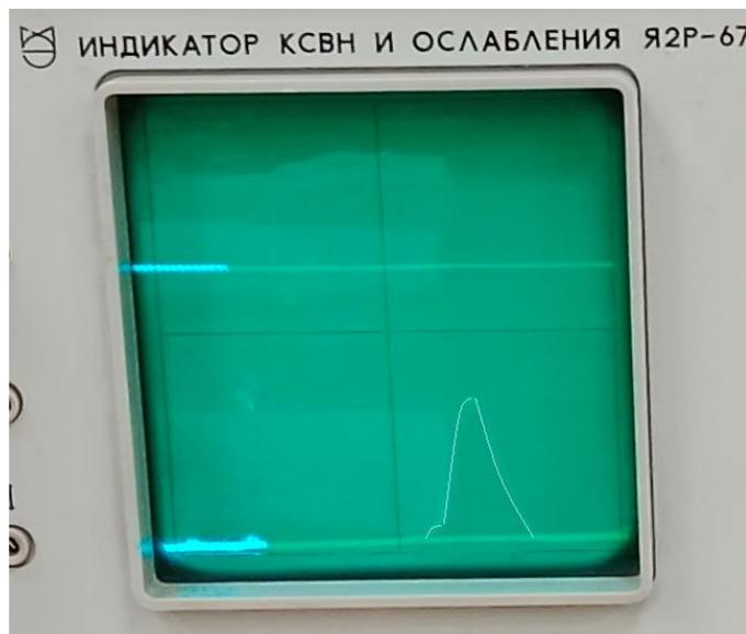
Рис. 5. Ослабление по каналу ответвления (уровень -2 дБ), центральная частота ответвления 3.2 ГГц. АЧХ ответвителя прорисована
