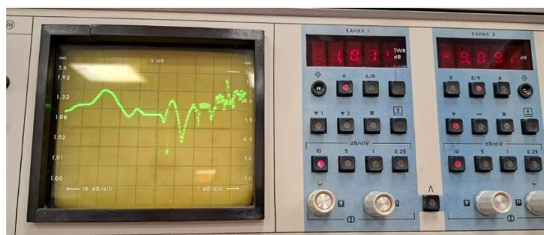
Рис. 6. Ослабление сигнала для пластины толщиной 2 мм
