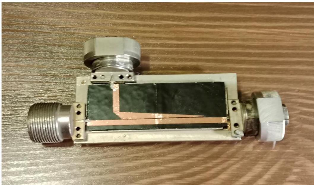
Рис. 3. Внешний вид ответвителя на нерегулярных линиях
