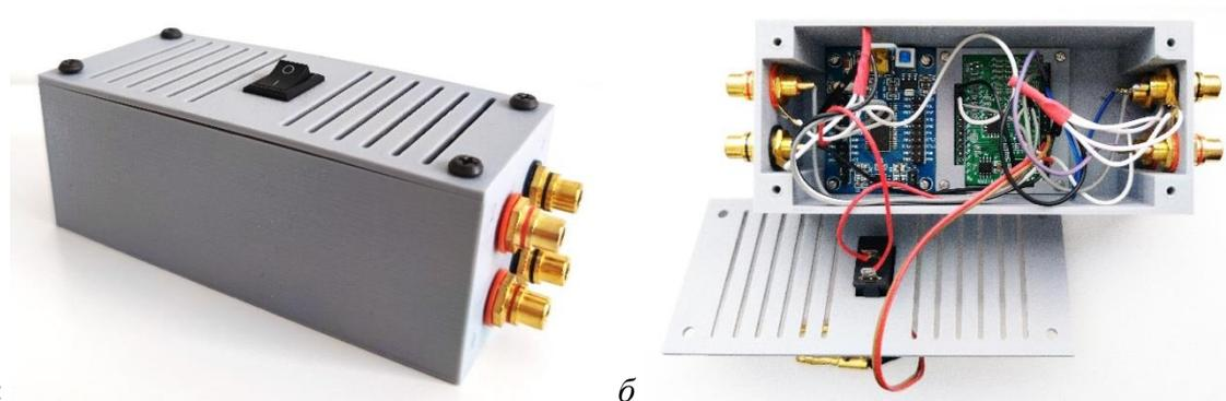
Рис. 1. Внешний (а) и внутренний (а) вид разработанного устройства ЦОС
