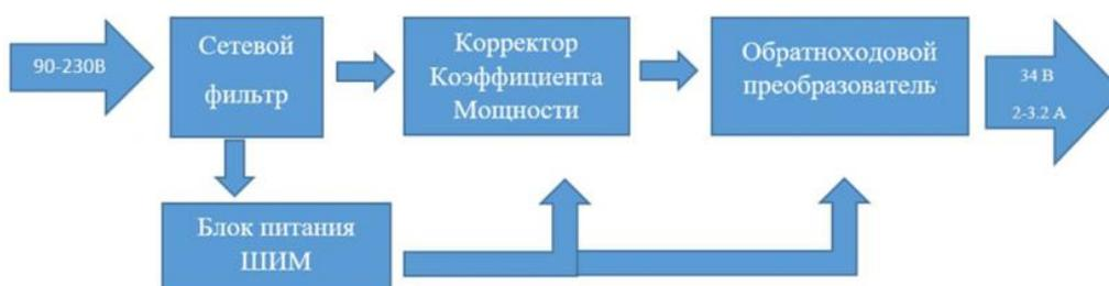
Рис. 1. Структурная схема ИВЭП
