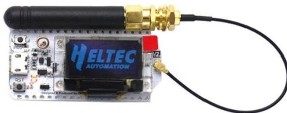
Рис. 1. Платформа HelTec Automation LoRa 32
