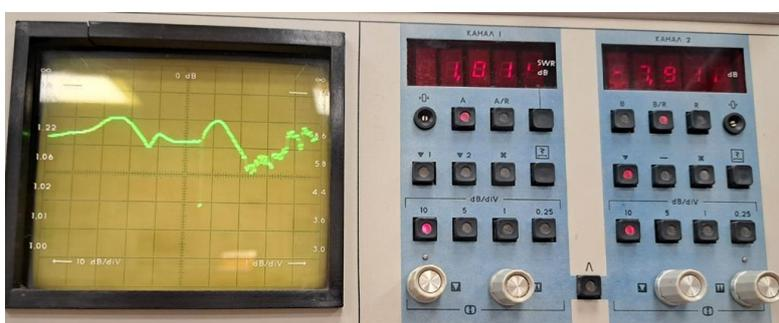
Рис. 7. Ослабление сигнала для пластины толщиной 4 мм
