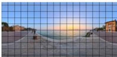
Рис. 1. Сферическое видео, отображенное на плоскость двумерного изображения с использованием равноугольной проекции
