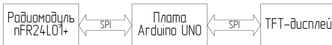
Рис. 1. Структурная схема сканера ISM-диапазона
