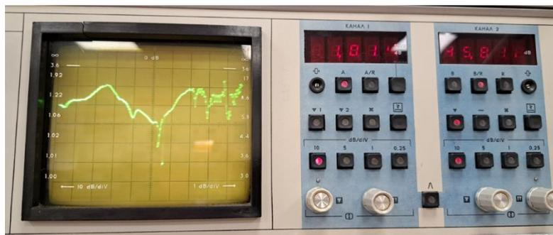
Рис. 5. Ослабление сигнала для пластины толщиной 1 мм
