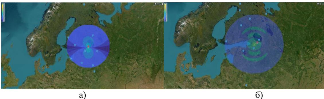
Рисунок 4. Зона покрытия: а) при равных весовых коэффициентах; б) при весовых коэффициентах, рассчитанных с помощью алгоритмов MUSIC или Beamscan;
