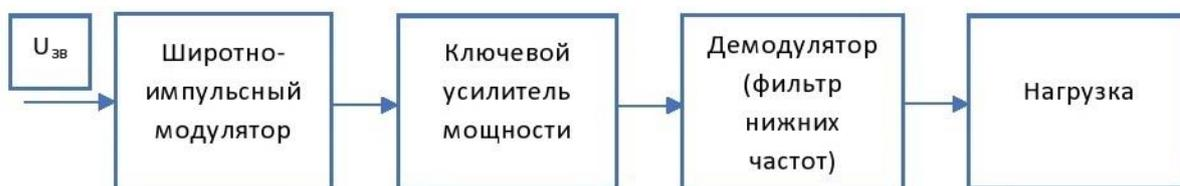
Рис. 1. Структурная схема однотактного усилителя класса *D*
