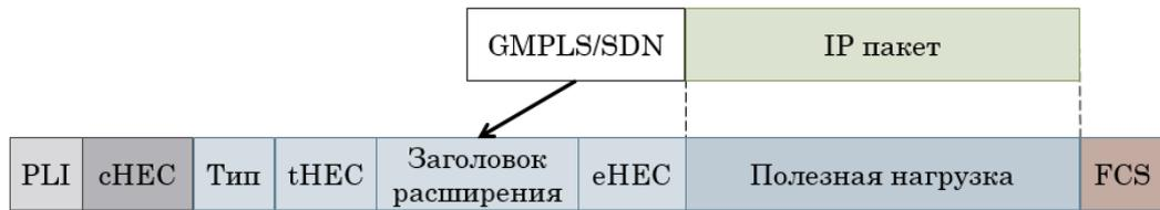
Рис. 2. Вариант размещения сигнализации в GFP-заголовке
