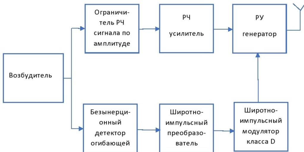
Рис. 2. Упрощенная структурная схема РПДУ, позволяющего осуществлять вещание в аналоговых и цифровых режимах
