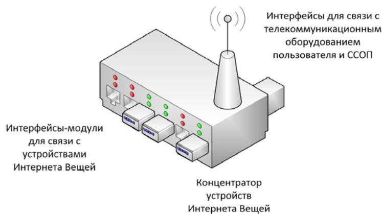
Рис. 2. Модульная структура концентратора устройств Интернета Вещей
