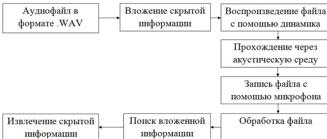
Рис. 1. Схема работы, предложенной стегосистемы
