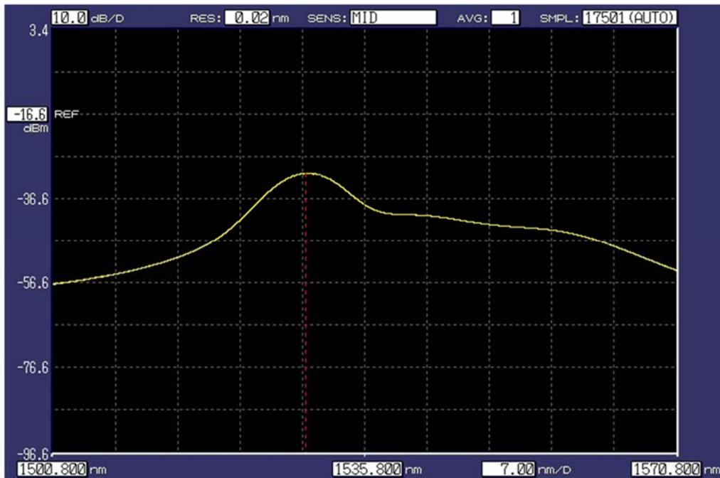
Рис. 2. Спектрограмма ASE при  $p_p = 22$  дБм и  $l_{\text{ЭВС}} = 13$  м
