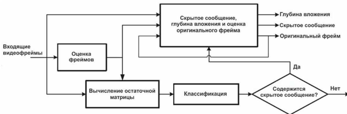
Рис. 5. Блок-схема предлагаемой системы стегоанализа
