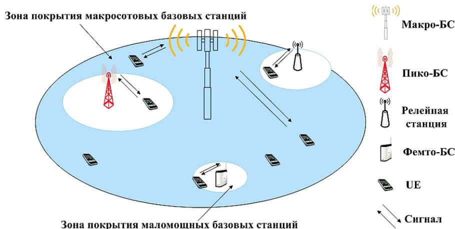
Рис. 1. Развёртывание гетерогенных сетей при использовании маломощных узлов
