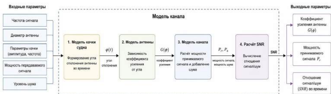
Рис. 1. Структура модели канала спутниковой связи с морскими судами.
