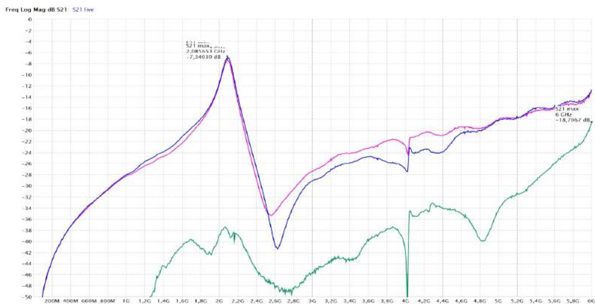
Рис. 4. Полученные в результате эксперимента характеристики изготовленного макета. Фиолетовый и синий графики – передача сигнала на выходные порты, зеленый – передача сигнала между входными портами.
