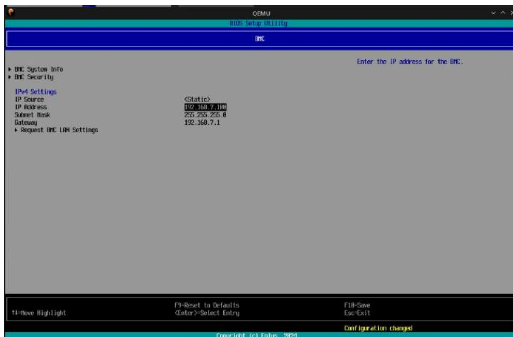
Рис. 2. Пример экранного интерфейса BIOS для конфигурации BMC
