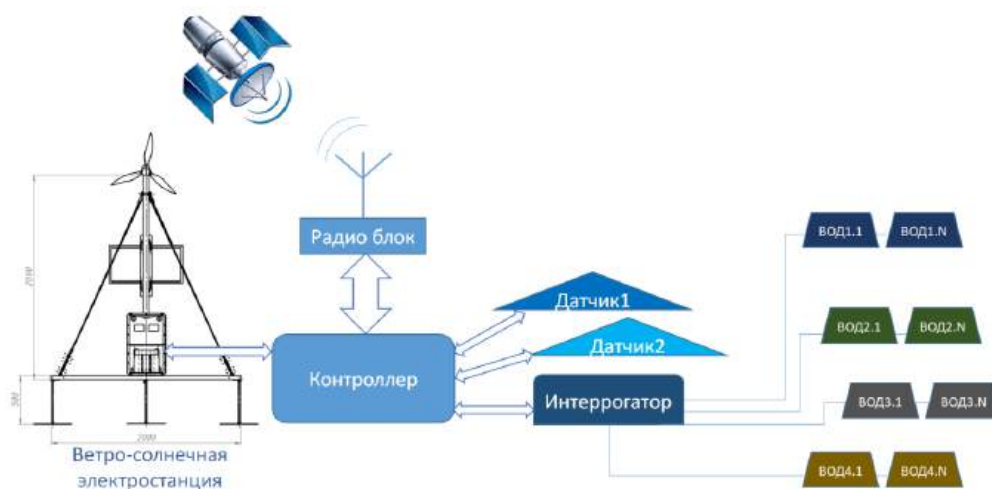
Рис. 1. Блок-схема комплекса природного мониторинга [10]
