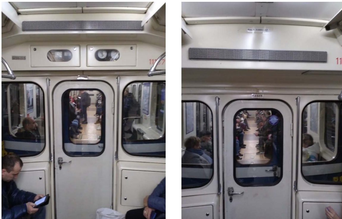
Рис. 2. Уровень сигнала рядом с приборной панелью составляет примерно -61 дБм, тогда как в противоположном конце вагона от той же ТД – уже около -46 дБм
