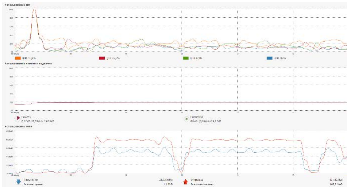
Рис. 1. Использование ресурсов процессора, оперативной памяти и состояния сети SDN-контроллера модельной сети в режиме Unit-тестирования при частоте подключения/отключения VM 10 секунд
