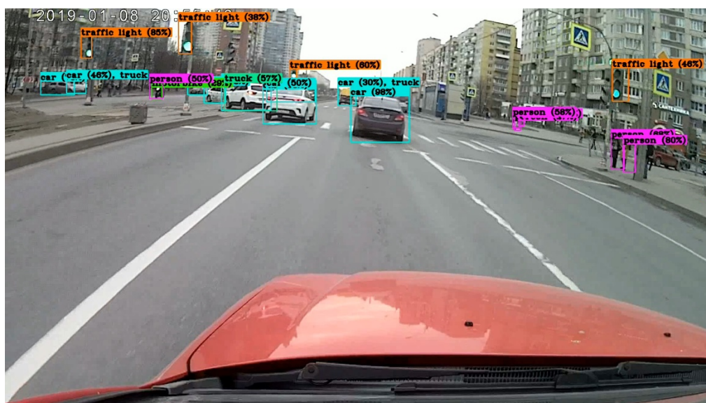
Рис. 2. Распознавание объектов на проезжей части моделью YOLOv3-608
