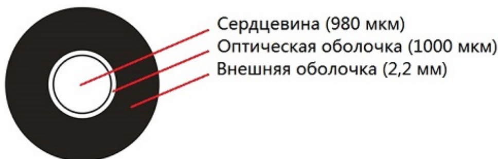
Рис. 2. Пример геометрических характеристик полимерного оптического волокна
