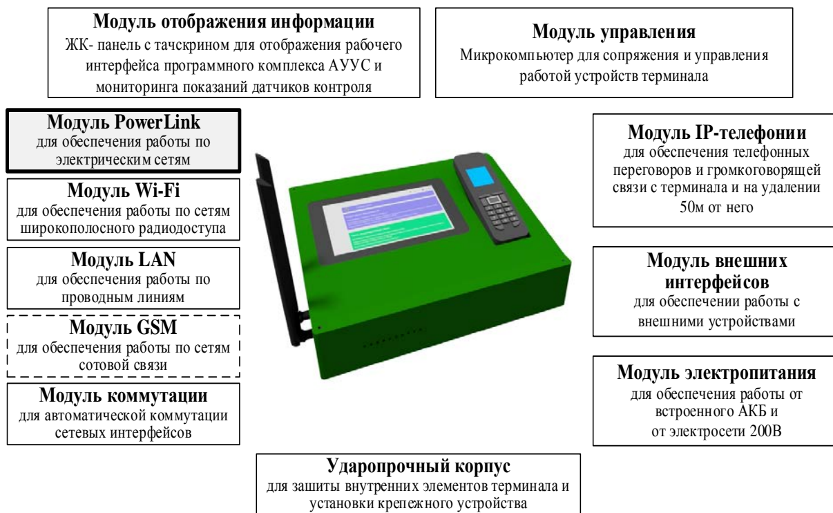
Рис. 1. Основные составляющие универсального терминального устройства служебной связи и управления «Терминала»
