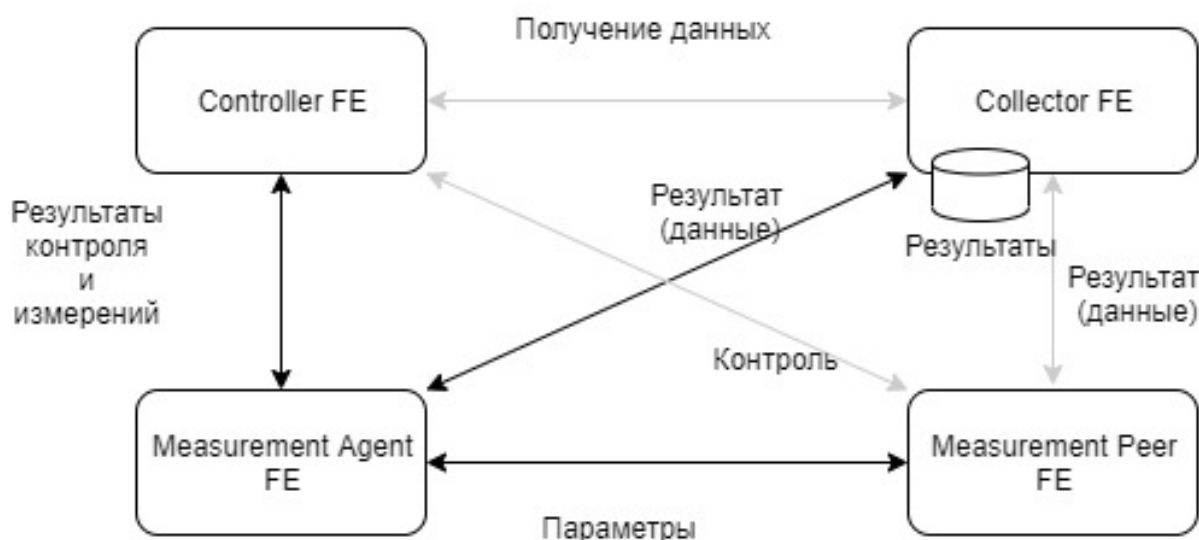
Рис. 1. Метод измерения скорости сети интернет на базе Рекомендации Q.3961 МСЭ-Т
