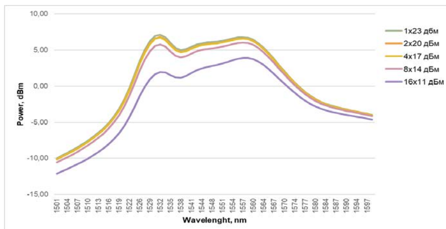
Рис. 6. Моделирование диапазона длин волн 1500–1600 нм с попутным включением сигнала накачки для 1, 2, 4, 8, 16 источников с различной мощностью накачки и уровнем мощности входного сигнала -10 дБм
