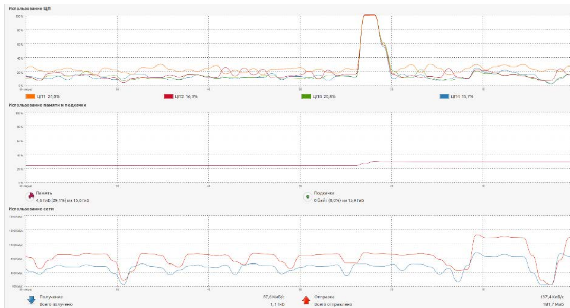
Рис. 4. Использование ресурсов процессора и оперативной памяти SDN-контроллера модельной сети в режиме Unit-тестирования при частоте подключения/отключения VM 10 миллисекунд
