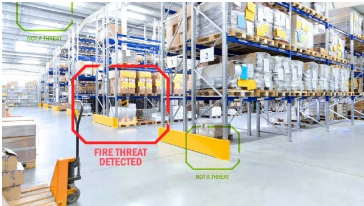
Рис. Детектирование признаков пожара пожарным извещателем с видеоканалом обнаружения
