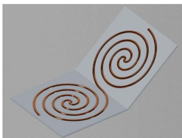
Рис. 7. 3D-модель ДПСА для оценки излучающих способностей в зависимости от угла между плоскостями
