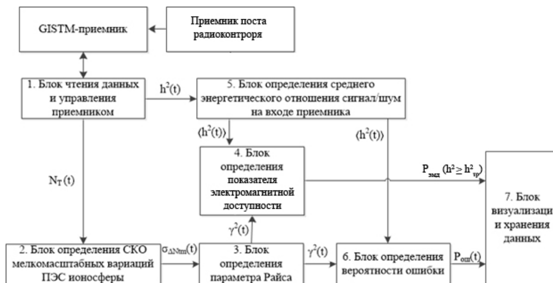
Рис. 1. Общая структурная схема комплекса прогнозирования показателей электромагнитной доступности, с пониженной несущей частотой
