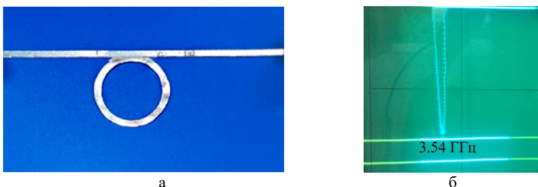
Рис. 2. Эллиптический кольцевой резонатора на МПЛ (а) и его экспериментальная АЧХ (б)
