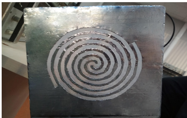
Рис. 5. Макет планарной щелевой спиральной структуры
