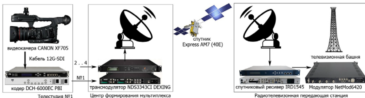
Рис. Схема создания и передачи видео кодеком H.265
