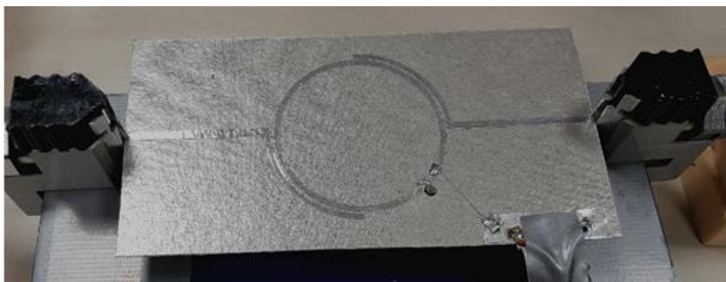
Рис. 6. Макет усилителя на активном двухполюснике, интегрированный в кольцевой эллиптический резонатор
