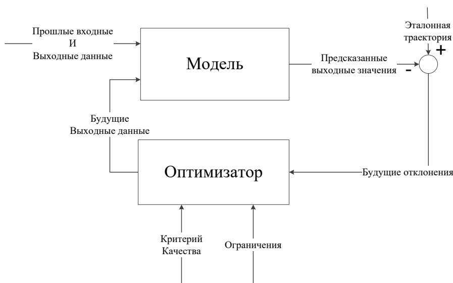
Рис. 2. Структура методологии управления с прогнозированием
