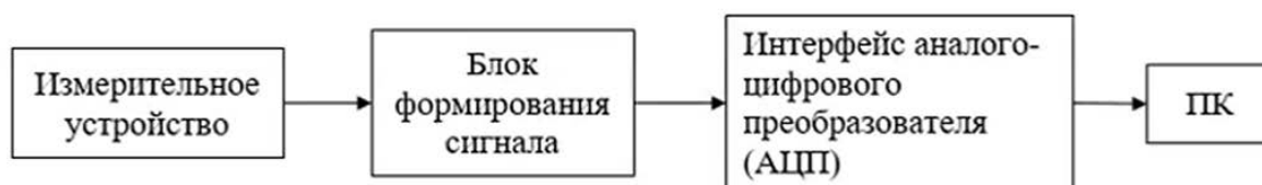
Рис. 2. Структура схема аудиометра, используемого в качестве основы для создания виртуального практикума по определению параметров дыхательной системы
