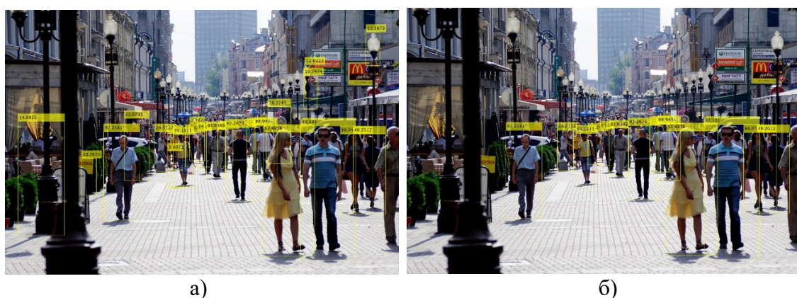
Рис. 4. Демонстрация работы детектора vision.CascadeObjectDetector без регулировки отображения (а), и с ограничением по отображению если элемент переменной score меньше 20 (б)
