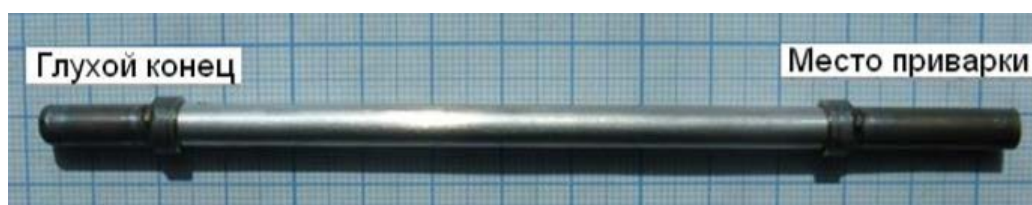
Рис. 1. Образец трубчатой мембраны из двойного ОЦК сплава ванадия с палладиевым покрытием внешней и внутренней сторон
