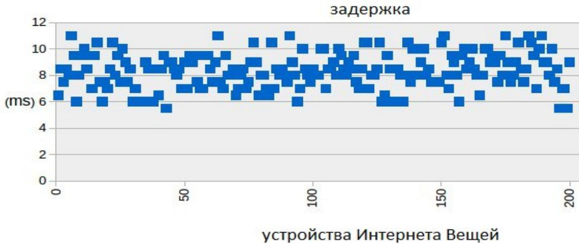
Рис. 2. Значение RTT протокола HTTP
