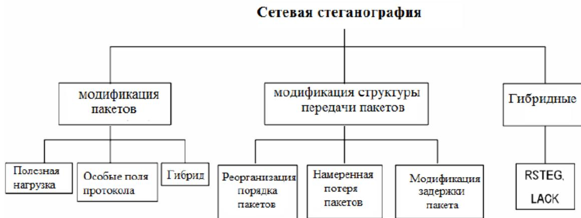
Рис. 1. Классификация методов канальной стеганографии
