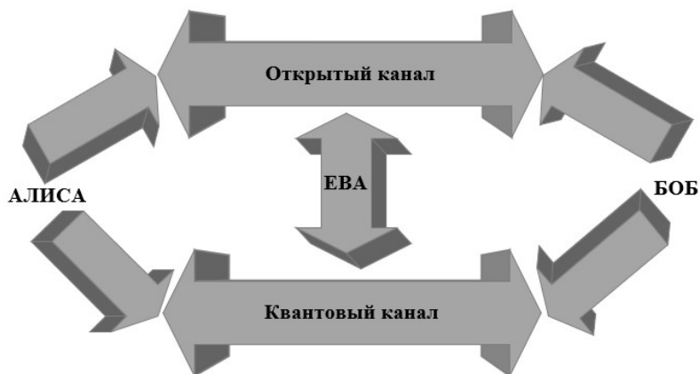
Рис. 1. Структурная схема работы протокола BB84
