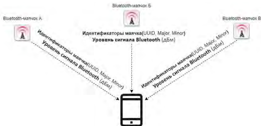
Рис. Принцип работы Bluetooth-маячков в технологии iBeacon
