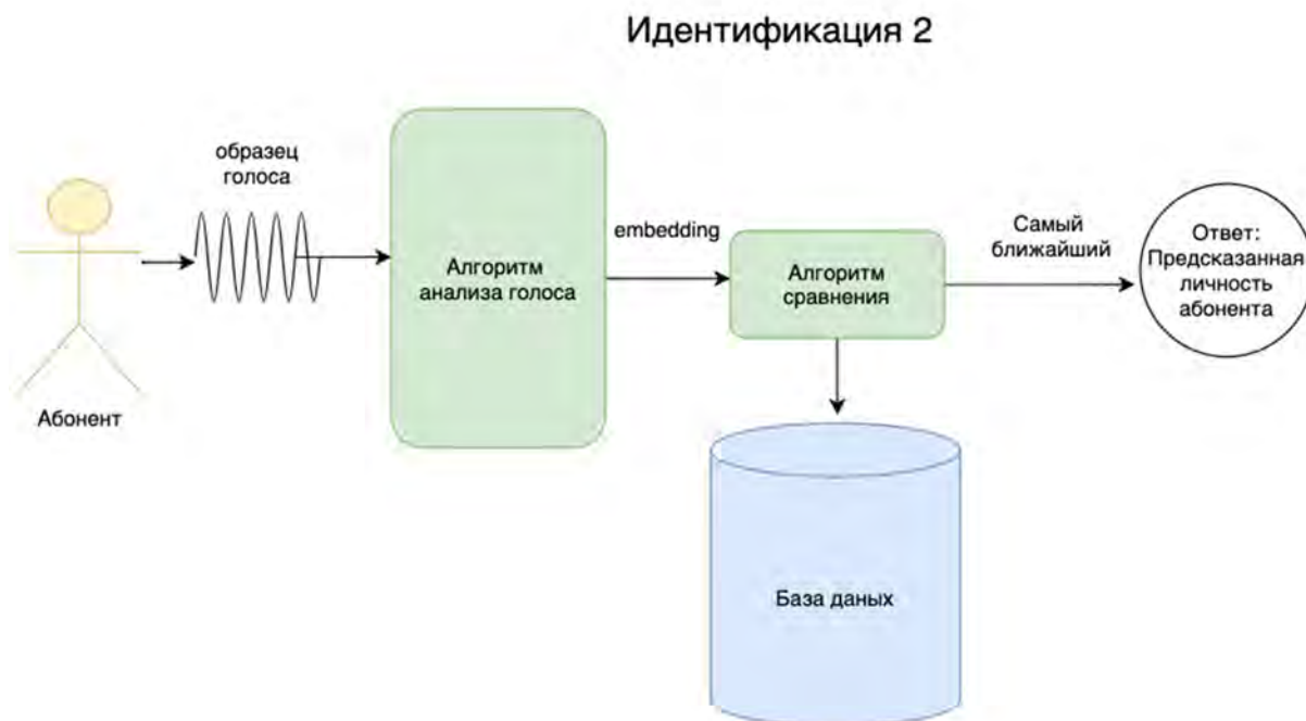
Рис. 5. Схема работы системы идентификации 2
