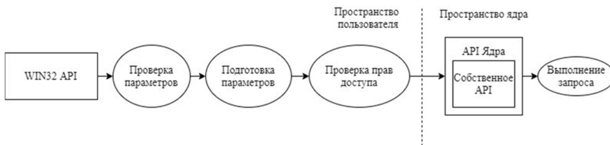
Рис. 1. Схема вызова API ядра
