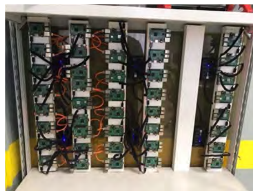
Рис. 2. Ферма Raspberry Pi
