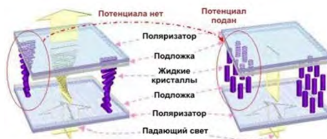
Рис. 2. Устройство ЖК-ячейки
