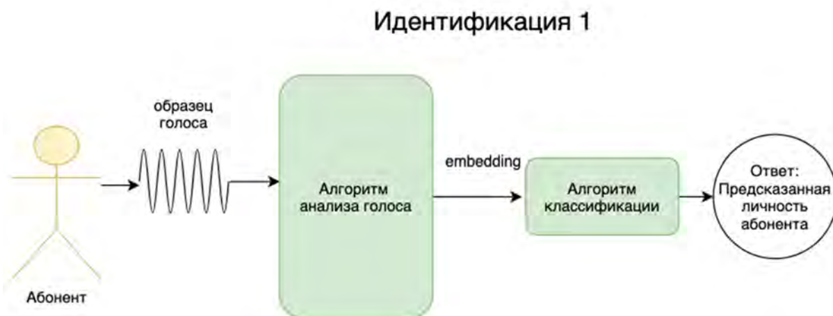
Рис. 4. Схема работы системы идентификации
