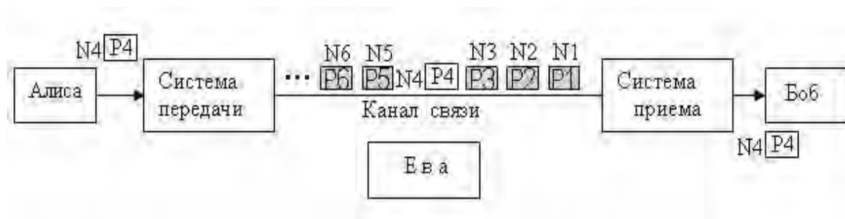
Рис. Структурная схема физического процесса передачи секретного сообщения с использованием файла-контейнера
