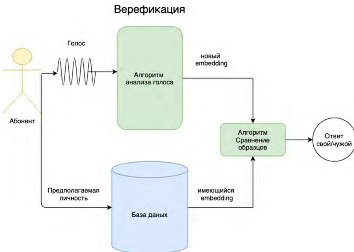
Рис. 2. Схема работы системы верификации
