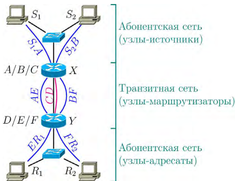
Рис. 2. Модельная сеть на основе двух маршрутизаторов и VPN-сетей
