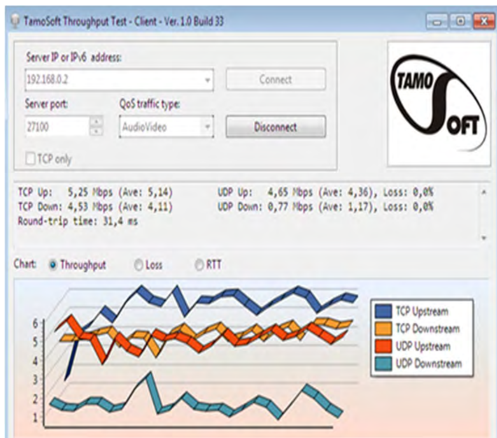
Рис. 3. Результаты теста при настроенном типе шифрования 3des и хеширования sha на схеме 1
