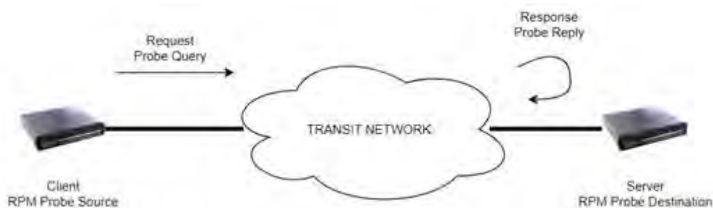
Рис. 3. Принцип работы Juniper RPM
