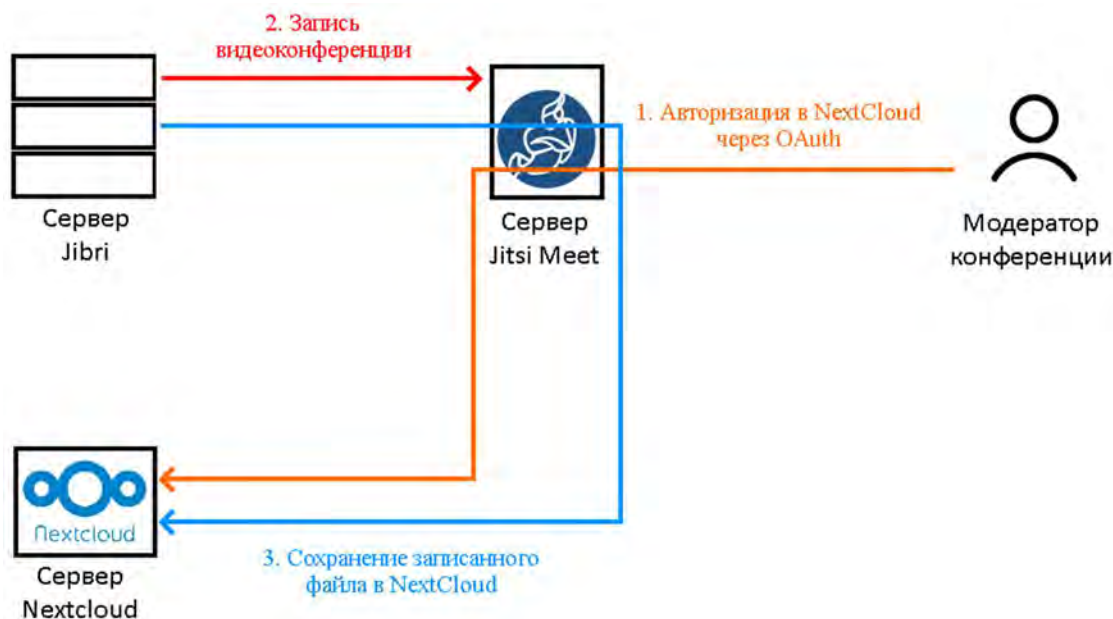
Рис. Принцип работы модуля интеграции NextCloud с веб-интерфейсом Jitsi Meet
