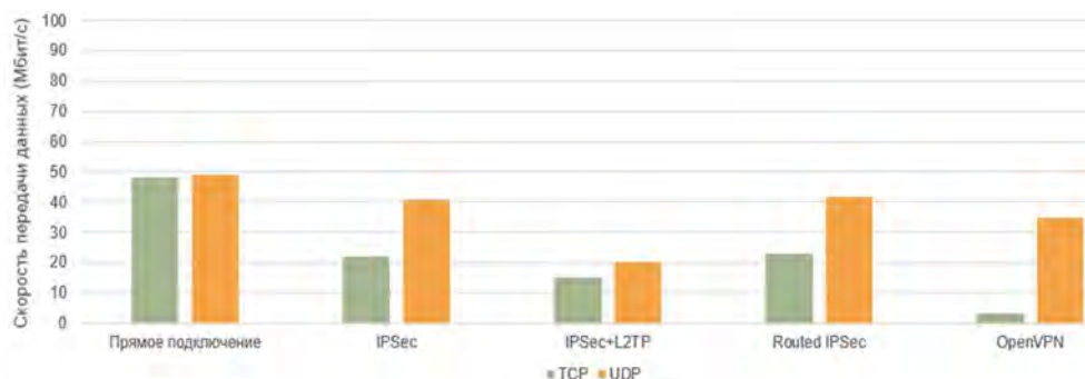
Рис. 4. Тест скорости с симуляцией плохого канала в режимах TCP/UDP
