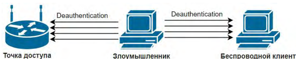
Рис. 4. Схема атаки deauthentication flood
