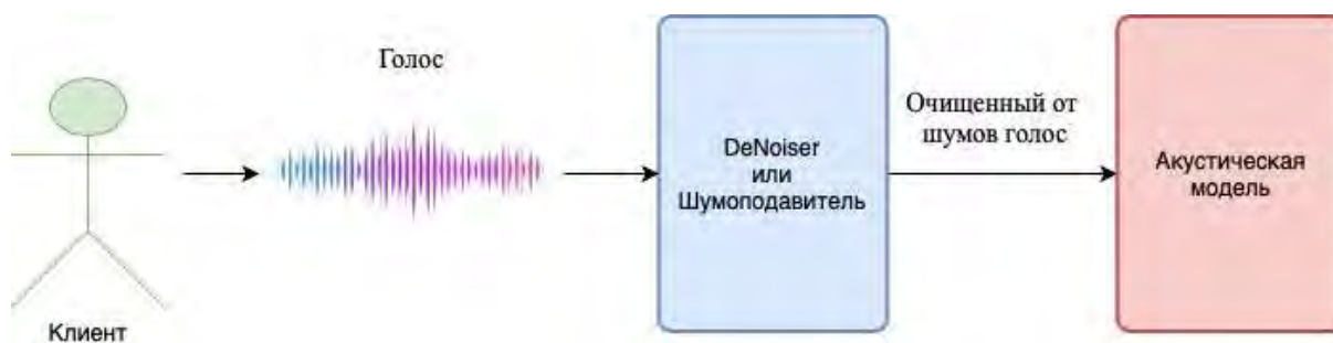
Рис. 2. Структура работы системы с денойзером
