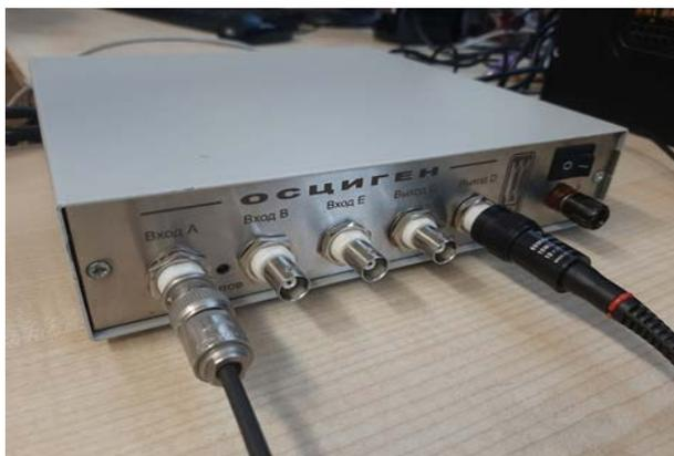
Рис. 3. Комбинированный прибор «ОСЦИГЕН»
