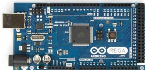
Рис. 5. Arduino Mega 2560
