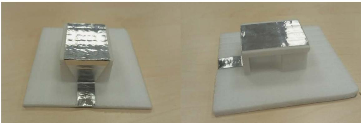
Рис. 7. Макет патч-излучателя с элементом согласования
