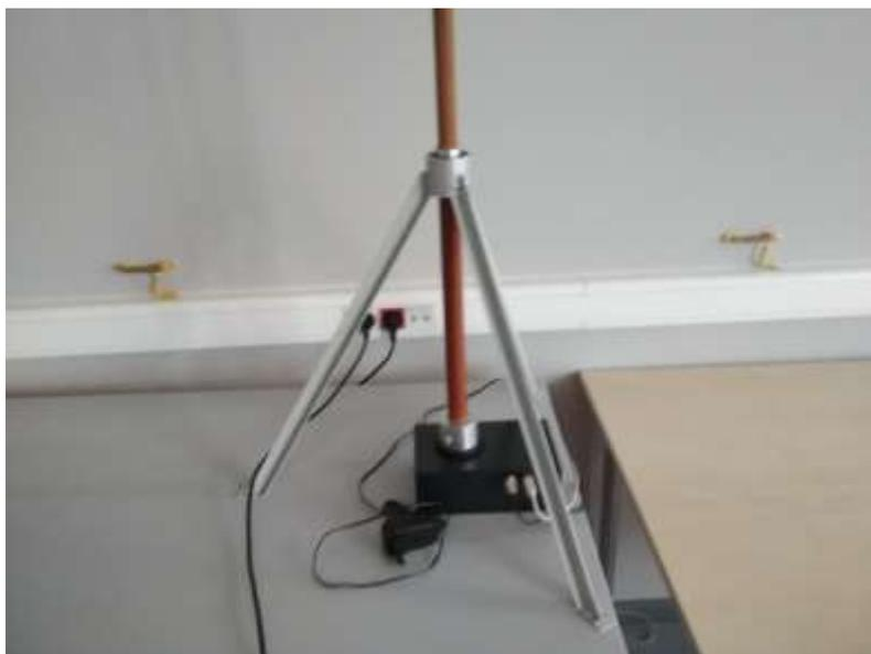
Рис. 4. Поворотное устройство, находящееся на уровне стола
