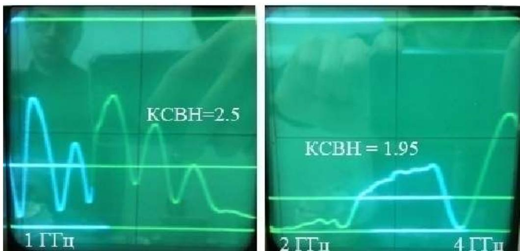
Рис. 6. Осциллограмма ЧХ КСВН Макета № 2 (рис. 4 в)
