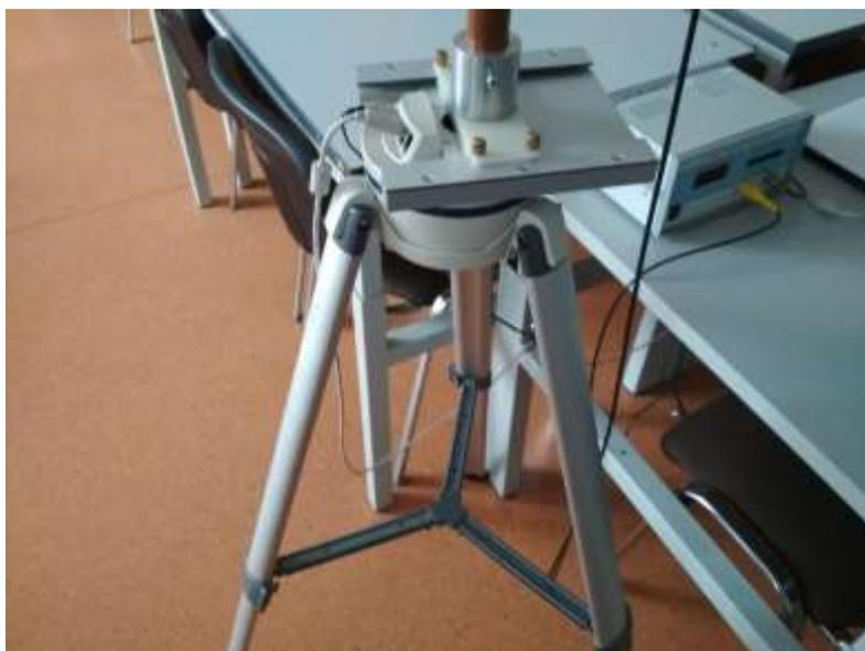
Рис. 3. Поворотное устройство, находящееся на уровне пола
