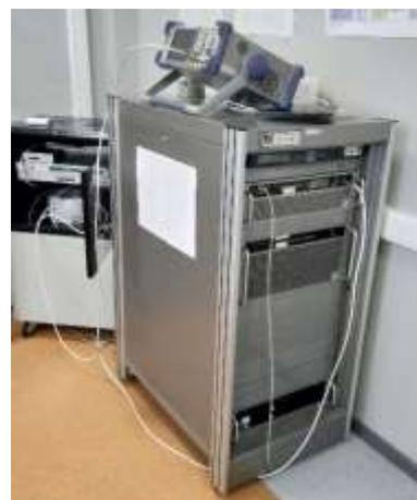
Рис. 1. Стенд для проверки работоспособности интерактивного устройства
