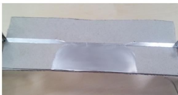
Рис. 10. Макет полосково-щелевого перехода с полным согласованием
