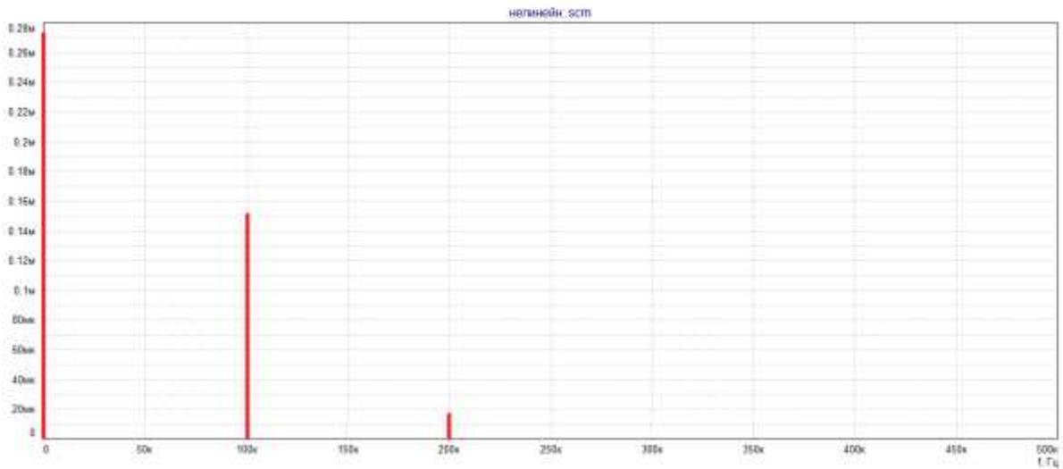
Рис. 5. График спектра амплитуд тока  $i(t)$  реакции нелинейного резистивного элемента в режиме малых колебаний
