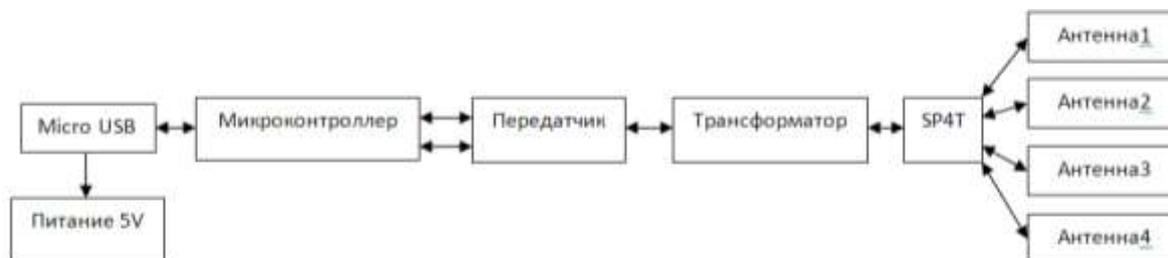
Рис. 2. Структурная схема модуля
