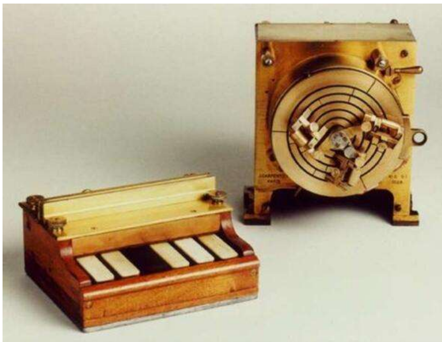
Рис. 5. Стартстопный телеграфный аппарат Ж. Бодо: клавиатура и распределитель. Центральный музей связи им. А. С. Попова
