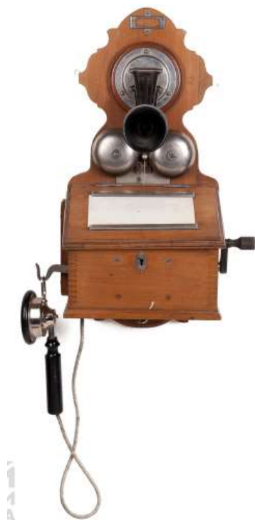
Рис. 7. Настенный телефонный аппарат индукторного вызова с микрофоном на подвижной штанге, ложкообразным наушником, поляризованным звонком и полочкой для письма. Siemens. Германия, 1890-е гг. Музей истории телефона
