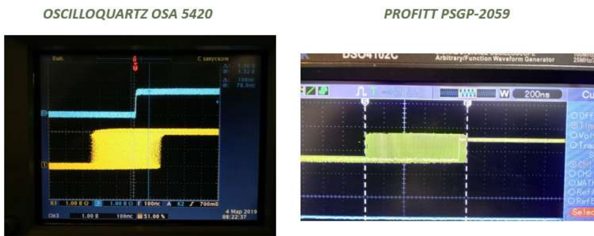
Рис. 3. Девиация времени относительно эталонного GPS приемника
