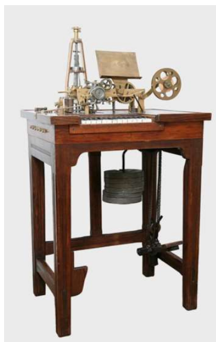
Рис. 4. Буквопечатающий телеграфный аппарат системы Юза с гиревым приводом. Фирма Дюмулен-Фромен. Франция. Конец XIX в. Центральный музей связи им. А. С. Попова
