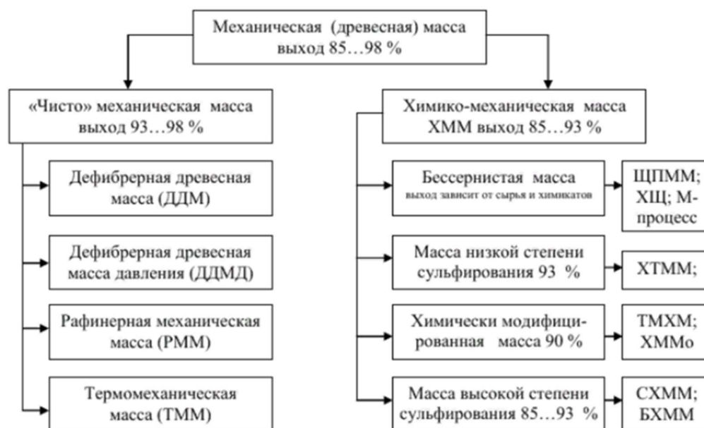
Рис. 3. Классификация механической (древесной) массы
