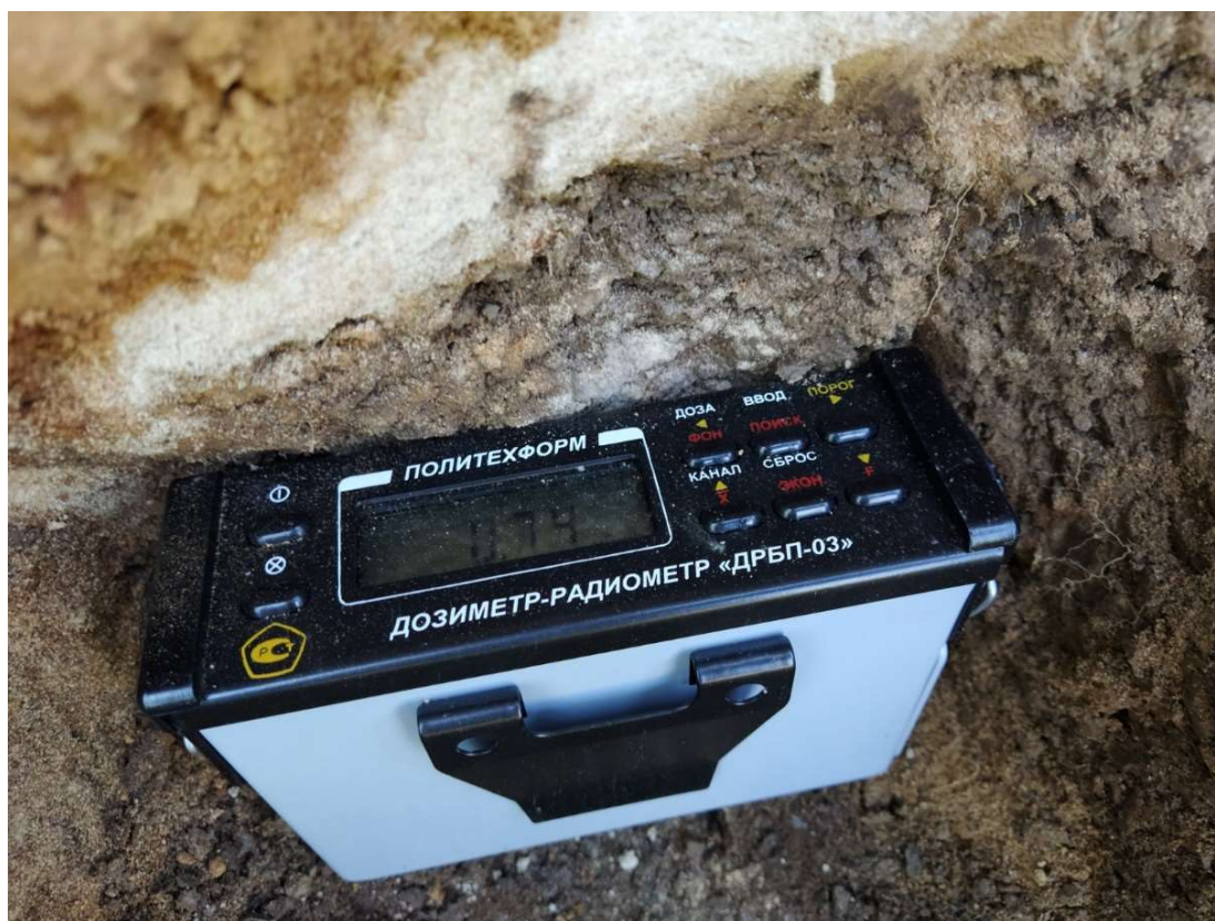
Рис. 4. Прибор для измерения МЭД расположен в шурфе (точка 1, 59^{\circ}41'48.4''N , 30^{\circ}10'42''E ) в районе обнажения диктионемовых сланцев на г. Кирхгоф, лето 2020 года. Фото В. А. Туманова
