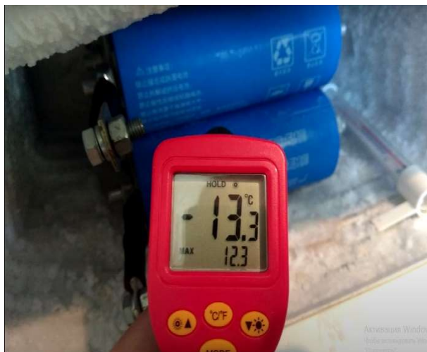
Рис. 6. LTO аккумуляторы при температуре минус 13 градусов
