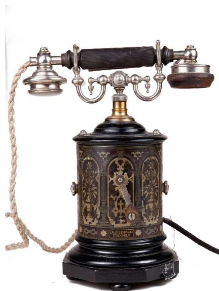
Рис. 9. Телефонный аппарат индукторного вызова с микротелефонной трубкой и поляризованным звонком, модель АС 210. Ericsson. Швеция, 1895. Музей истории телефона
