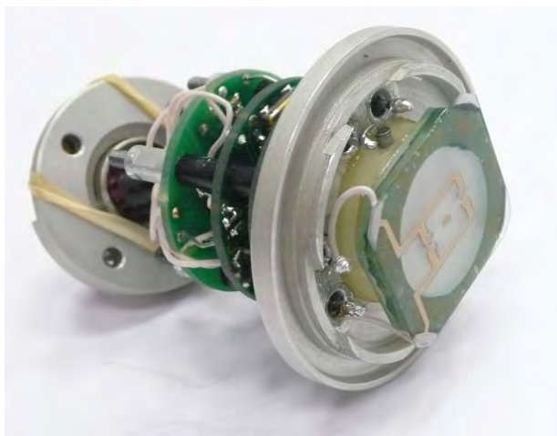
Рис. 4. Датчик давления ДДАЭ-И в разобранном виде
