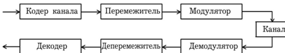
Рис. 1. Блок-схема системы связи, использующей перемежитель
