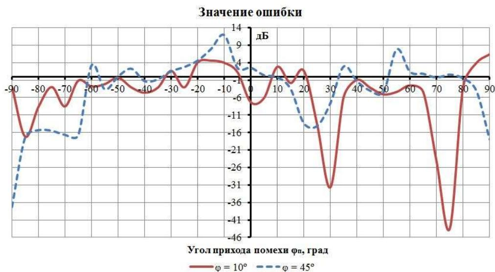
Рис. 2. Значение ошибки при угле прихода полезного сигнала  $10^\circ$  и  $45^\circ$
