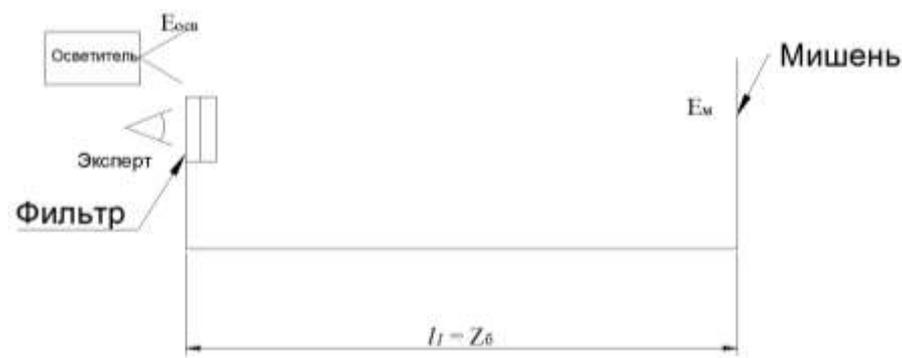
Рис. 2. Схема стенда подбора освещенности
