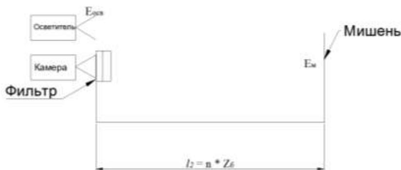
Рис. 1. Схема стенда проверки дальности видения камеры
