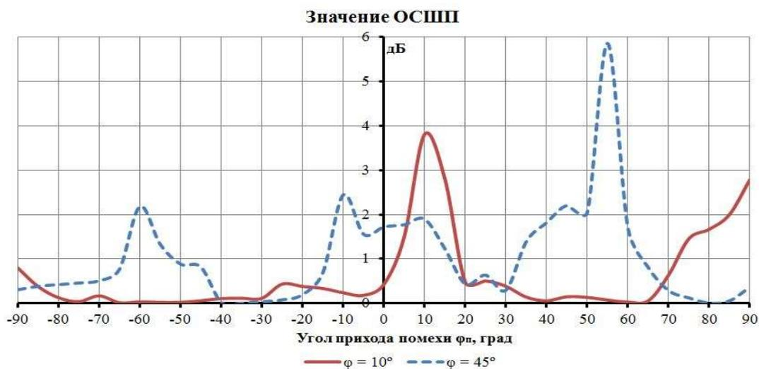
Рис. 3. Значение ОСШП при угле прихода полезного сигнала  $10^\circ$  и  $45^\circ$
