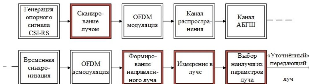
Рис. 1. Основные этапы обработки при процедуре P-2
