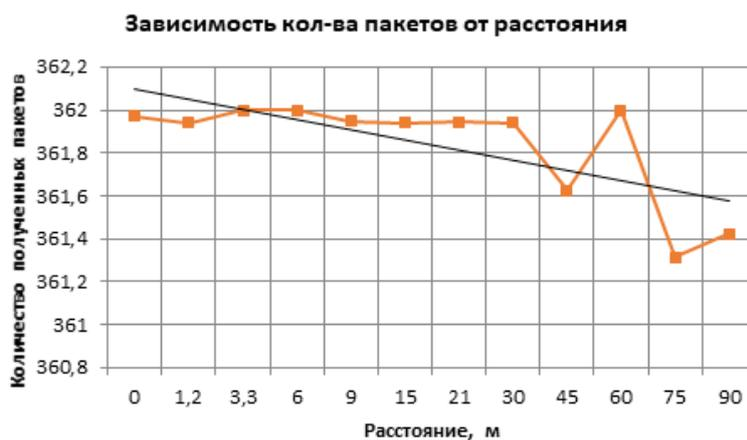
Рис. 3. Зависимость количества полученных пакетов от расстояния между передатчиком и приемником
