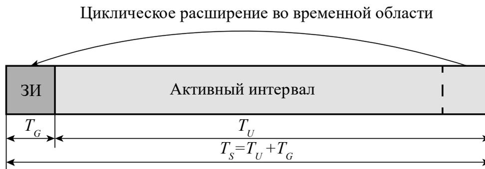
Рис. 1. Общая длительность символа OFDM сигнала, где ЗИ – защитный интервал
