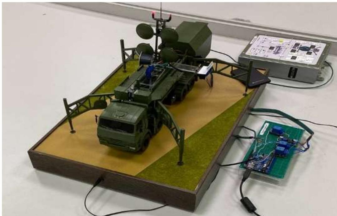
Рис. 1. Модель автоматического развёртывания антенного модуля Р-431АМ
