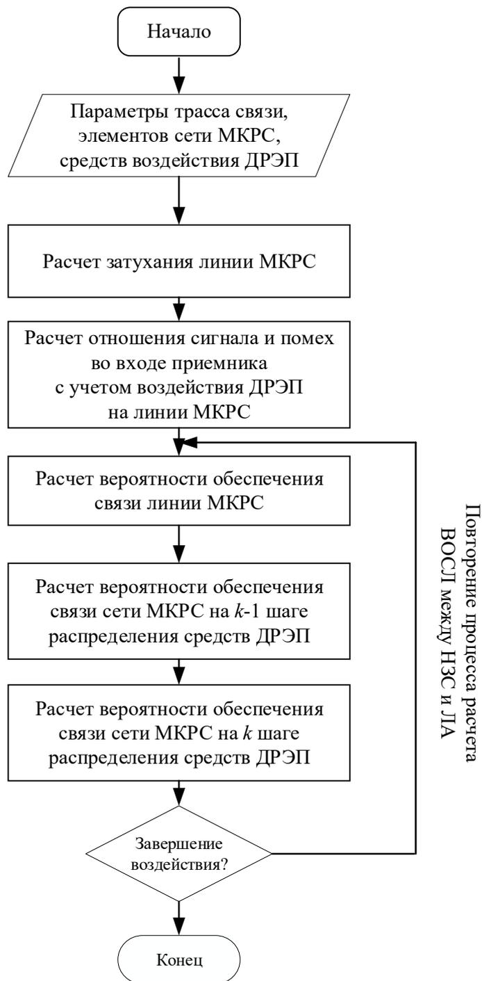
Рис. 3. Алгоритм оценки степени воздействия ДРЭП на сети МКРС
