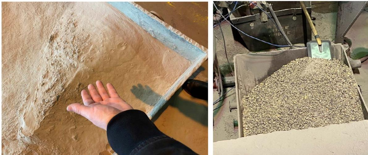
Рис. 2. Отработанные формовочные смеси на литейном производстве АО «Невский завод»
